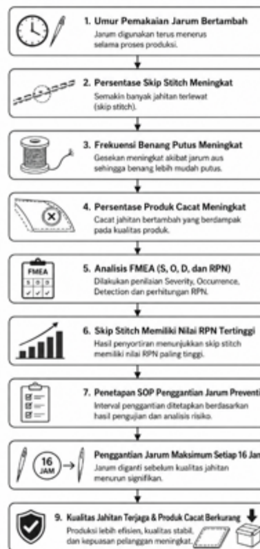
Gambar 5. Skema Pengambilan Keputusan Penetapan SOP Penggantian Jarum Mesin Jahit Walking Foot Berdasarkan Hasil Pengujian dan Analisis FMEA
